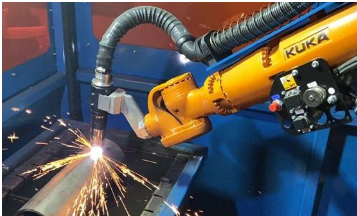
(ค) เครื่องตัดแบบอัตโนมัติด้วยหุ่นยนต์ (Robotic plasma cutting) ที่มา : Industrial Robotics – Robotmaster, 2021
