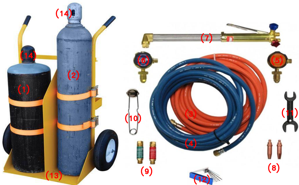
รูปที่ 2.2 เครื่องมือและอุปกรณ์ในการตัดด้วยแก๊สออกซิเจน
