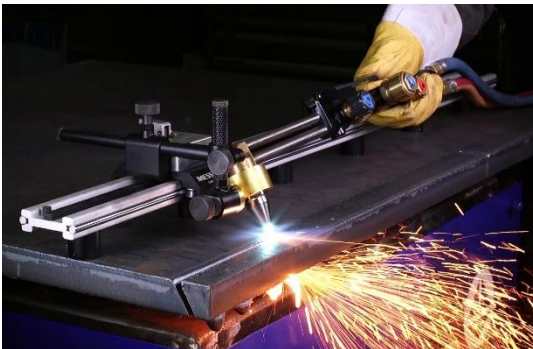
(ก) อุปกรณ์ตัดเอียง (Bevel cutting)
