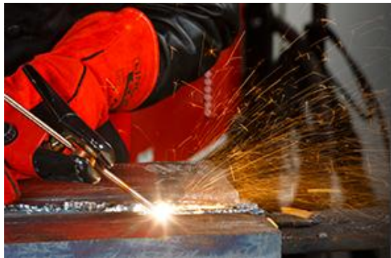
รูปการตัดเซาะร่องด้วย อากาศ-คาร์บอนอาร์ก ที่มา : Air Carbon Arc Gouging, 2015
