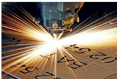
(ก) การตัดด้วยเลเซอร์โลหะแผ่นบาง
