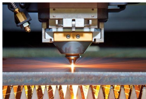
(ข) การตัดด้วยเลเซอร์โลหะแผ่นหนา
