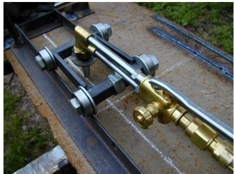
(ข) อุปกรณ์ตัดตรง (Straight cutting)
